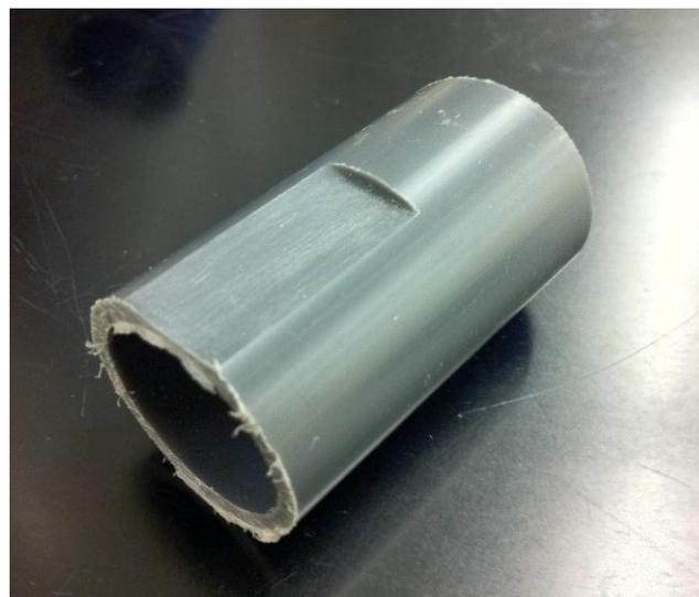
**Figura 70.** Pieza central de la cazoleta donde se puede observar la operación de fresado sobre la tubería.
