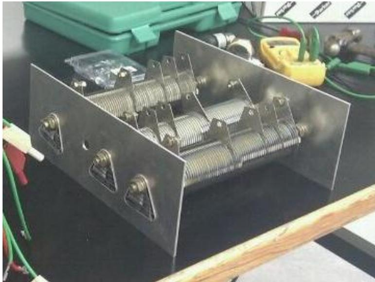
**Figura 86.** Resistencias variables utilizadas en la instalación
