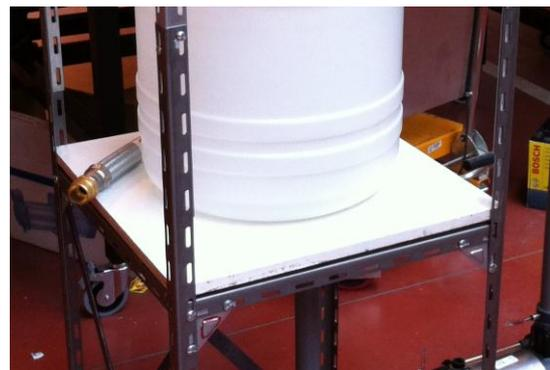
**Figura 37.** Estructura de apoyo del depósito
