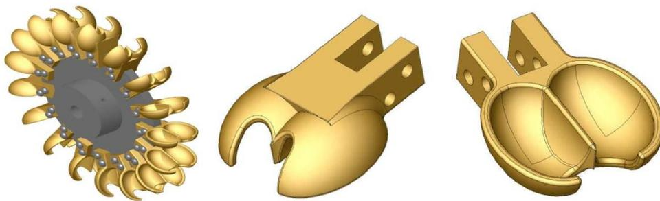
**Figura 22.** Rodete y cucharas de una Turbina Pelton
