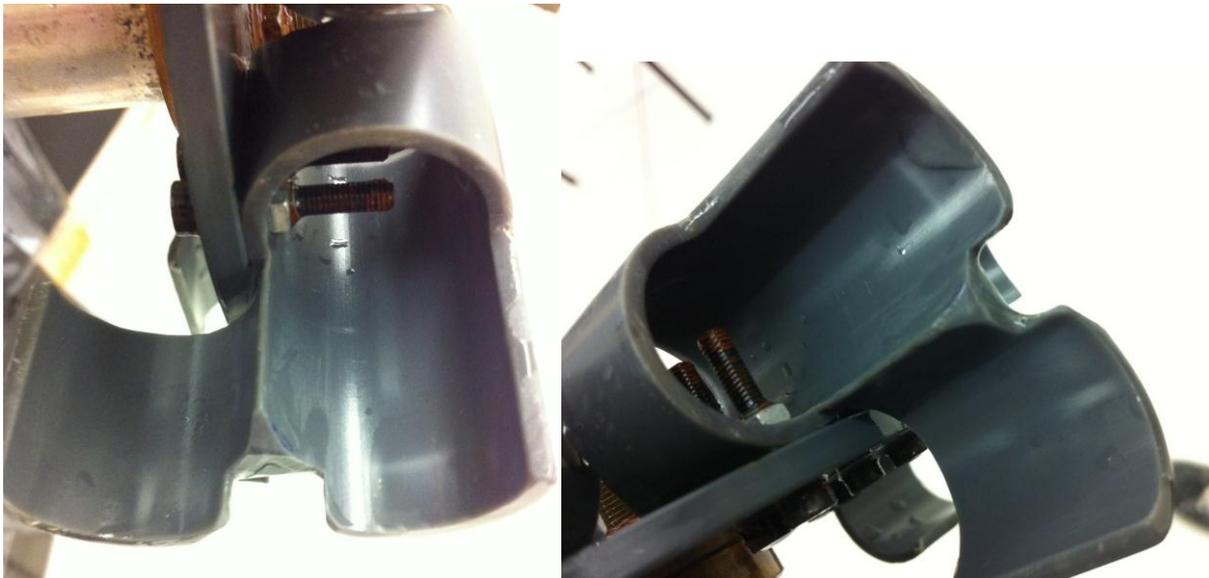
**Figura 136.** Muecas causadas por el uso en la turbina Pelton
