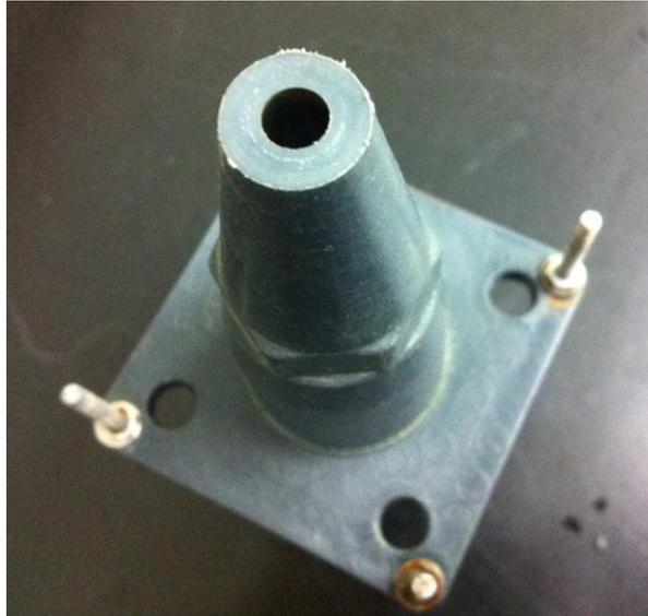
**Figura 82.** Fotografía de la tobera tras realizar la primera operación de apertura de 4,5 mm de diámetro de salida
