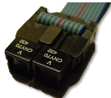
**Figura 43** Detalle de la conexión de los sensores CNY70
