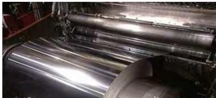
*Figura 24. Enrollado de lámina de aluminio [40]*
