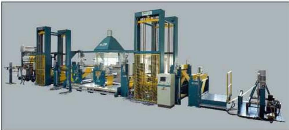
*Figura 18. Línea de producción de láminas de litio para baterías [35]*
