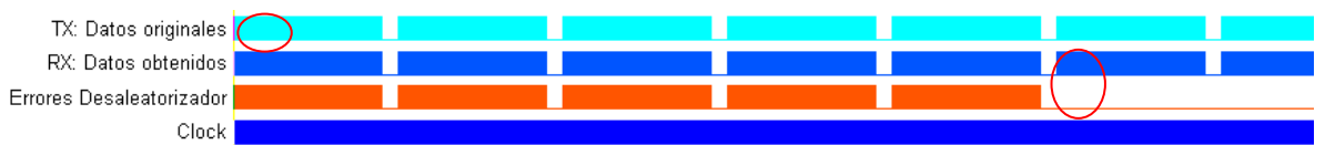
Figura 191: Validación de los datos obtenidos. Forma general de la señales de entrada y salida con fuente de 1 bit
