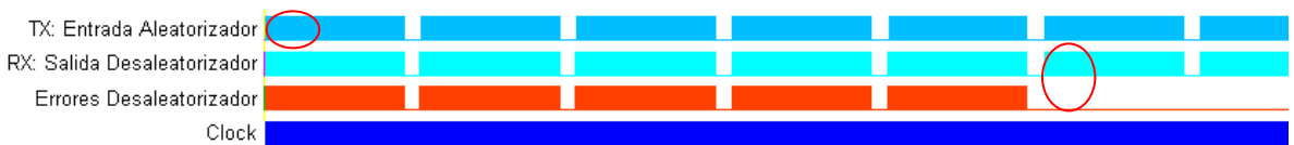
Figura 188: Validación del Desaleatorizador. Forma general de la señales de entrada y salida con fuente de 8 bits
