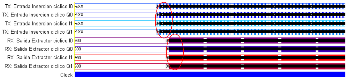
Figura 140: Validación del Extractor del prefijo ciclico. Forma general de la señales de entrada y salida con fuente de 8 bits
