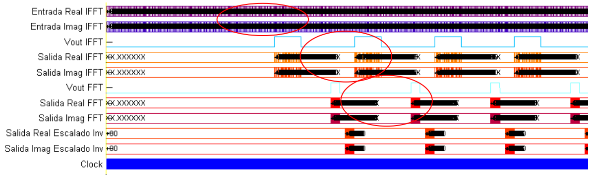
Figura 81: Ejemplo funcionamiento del bloque Xilinx FFT v1_0. Forma de la señales (ruptura del flujo continuo de datos en IFFT y FFT)
