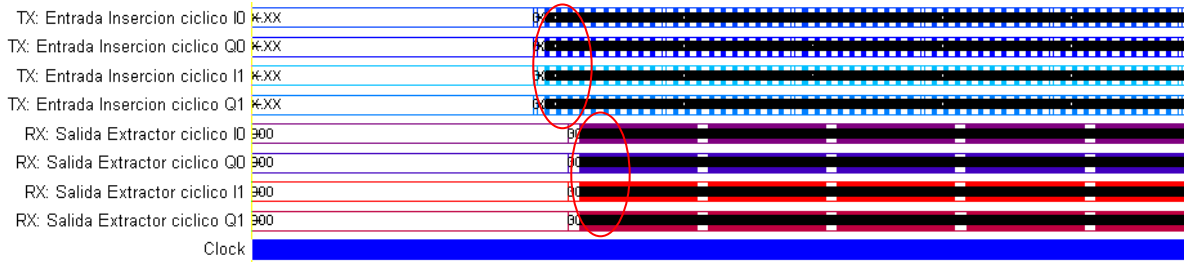
Figura 137: Validación del Extractor del prefijo ciclico. Forma general de la señales de entrada y salida con fuente de 1 bit
