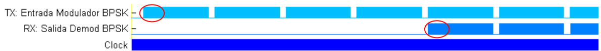
Figura 164: Validación del Demodulador. Forma general de la señales de entrada y salida con fuente de 8 bits
