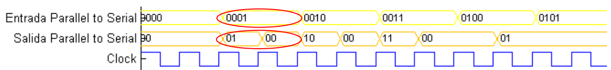
Figura 37: Ejemplo funcionamiento del bloque Xilinx Parallel to Serial . Forma de la señales
