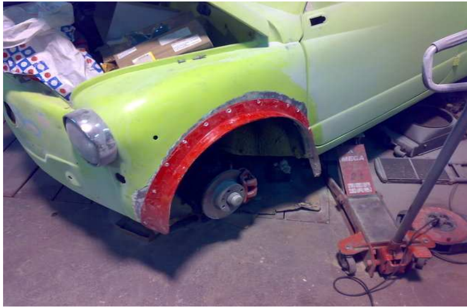
Figura 70: Fotografía de remachamiento de aletines
