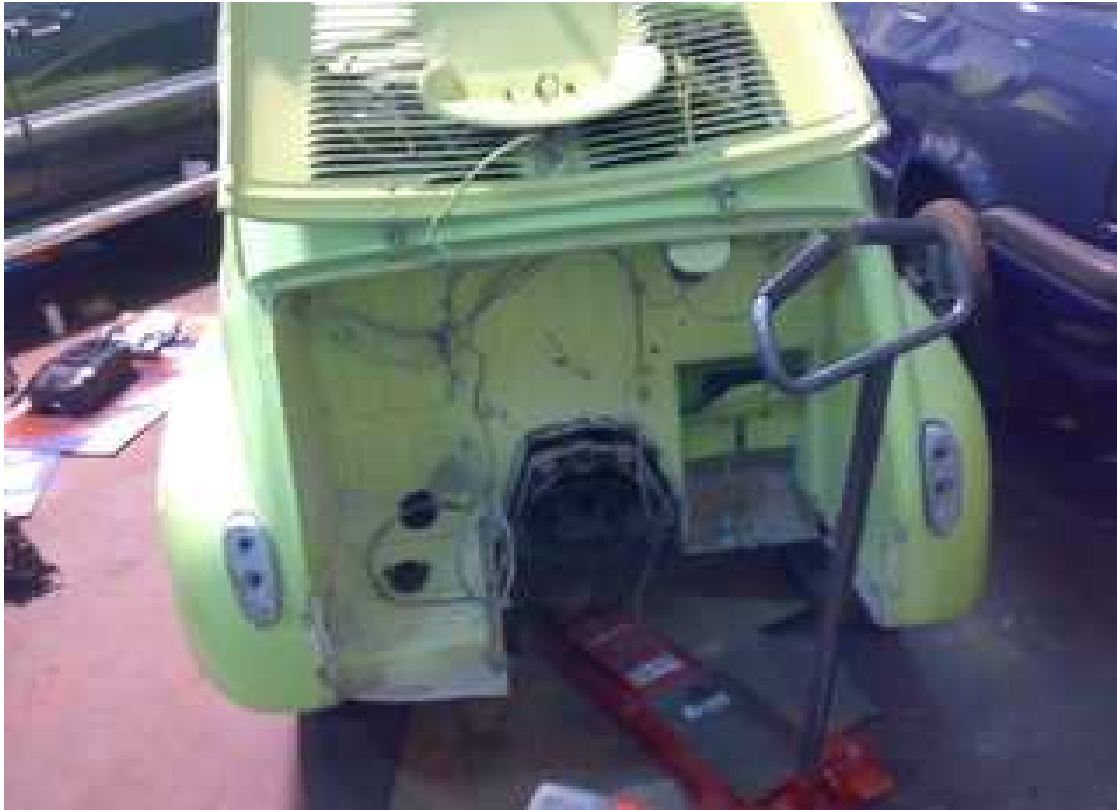
Figura 36: Desmontaje de motor original
