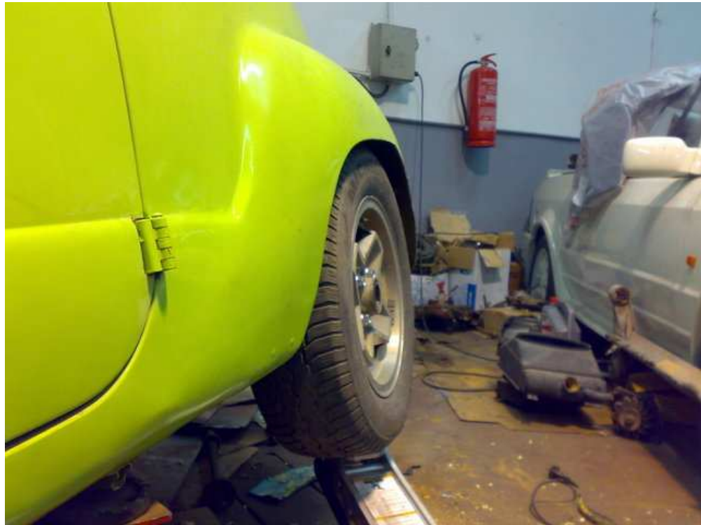
Figura76: Fotografía del vehículo con separadores traseros instalados
