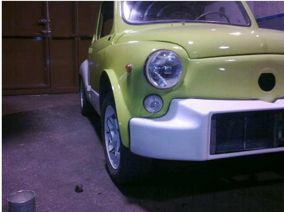
Figura 74: Fotografía del vehículo con separadores delanteros instalados
