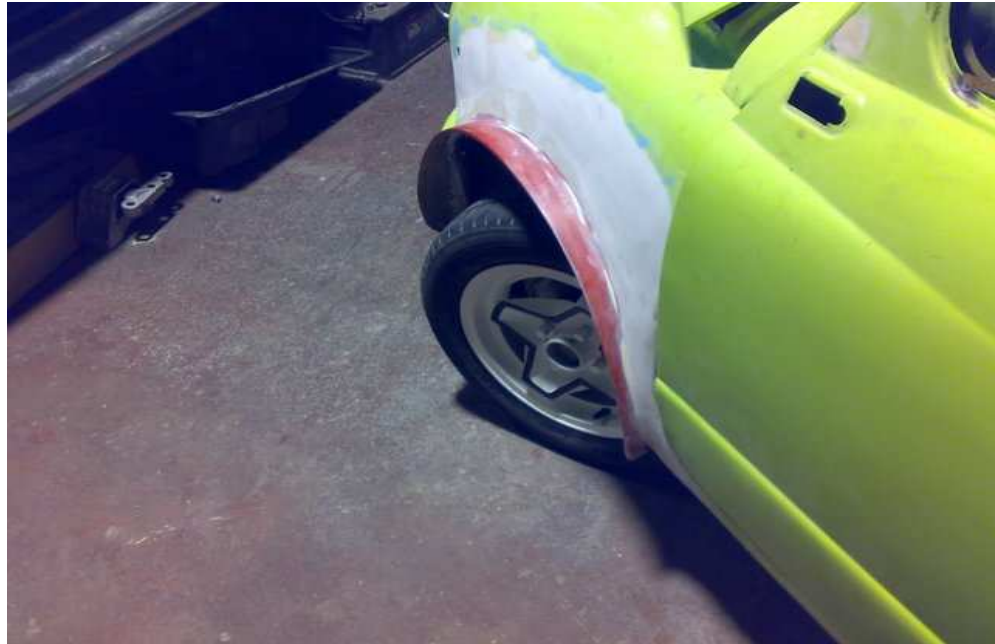
Figura 72: Fotografía de acabado en aletines
