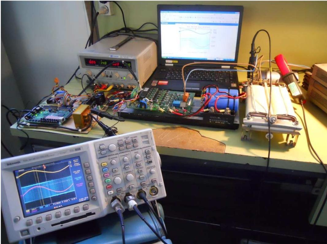
*Figura 7.5. Banco de pruebas del inversor*
