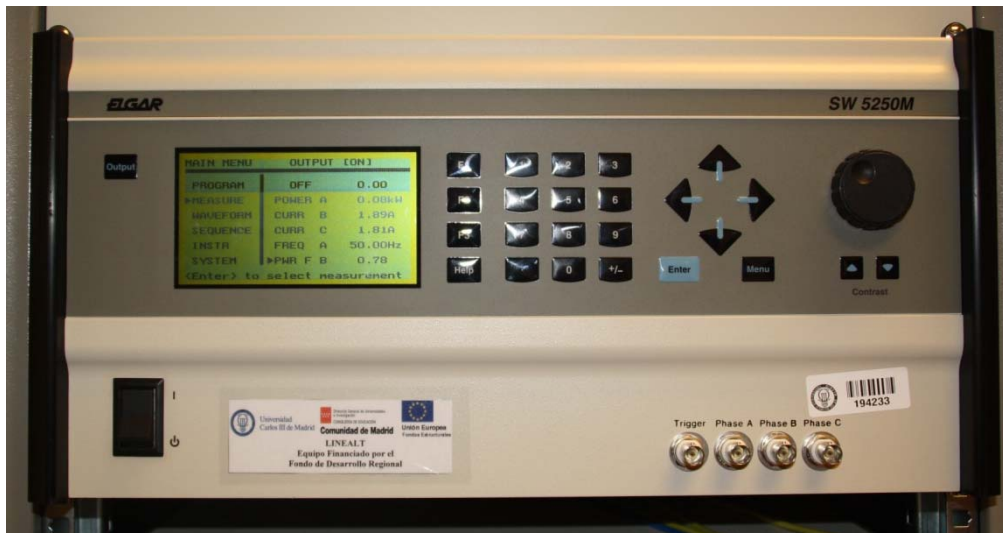
Fig. 5.5. Detalle del panel frontal de la fuente trifásica
