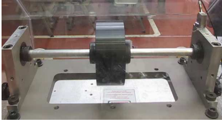
Figura 71. Eje de aluminio con disco de acero montado en el banco de ensayos.
