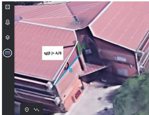
Figura 9.5. MÉTODO DE OBTENCIÓN DE INCLINACIONES DE LOS FALDONES. [Fuente: Elaboración propia]
