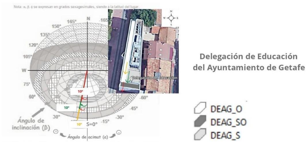
Figura 9.12. ORIENTACIONES ESTIMADAS PARA LOS MÓDULOS DE LAS CUBIERTAS DEL PMJCM Y CCA. [Fuente: Elaboración propia]
