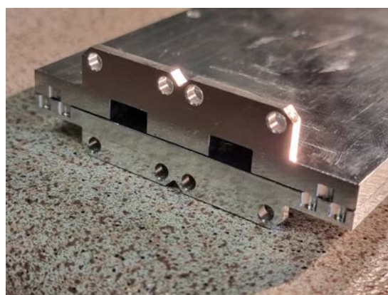
(d) Detail of the WR34 input ports.
