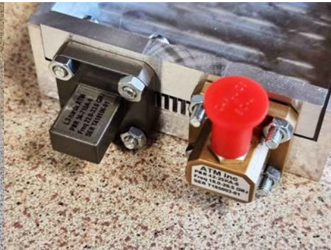
(d) Detail of the input ports for measurements. WR34 flange (port 1) + matched load (port 2).
