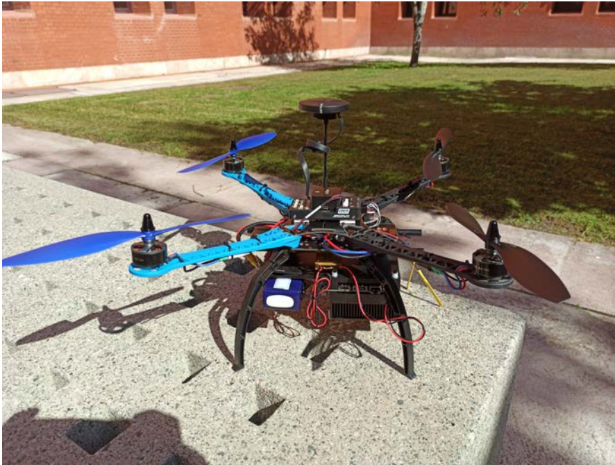
Figura B.9: Prototipo demostrador empleado para vuelo autónomo y coordinada en enjambre.
