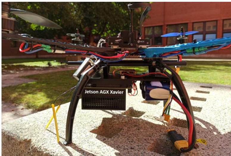
Figura B.5: Jetson AGX Xavier embarcada sobre UAV.
