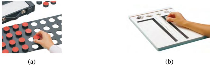
Fig. 2.1. Pruebas tradicionales de evaluación de la función del miembro superior. (a) Test de Minnesota de Destreza Manual (MRMT). (b) Test Purdue Pegboard (PPT).
