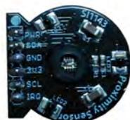
Fig. 4.1. Sensor de proximidad SI1143.
