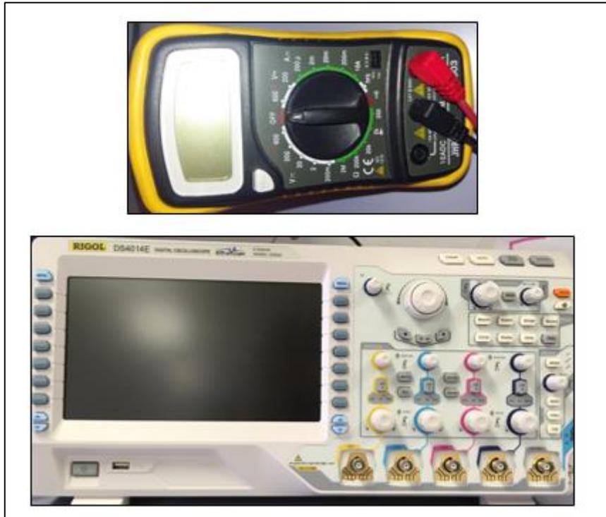
*Figura 2.4. Polímetro y osciloscopio utilizados*
