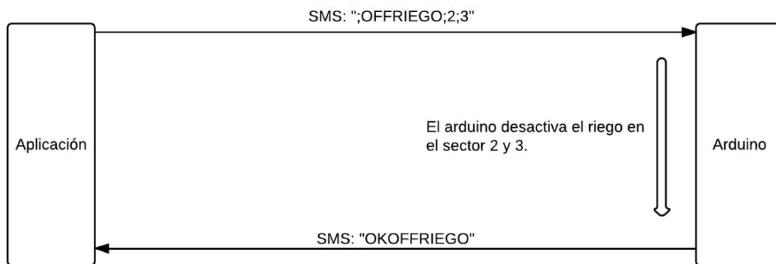
Ilustración 22: funcionamiento del sistema desactivación regadío
