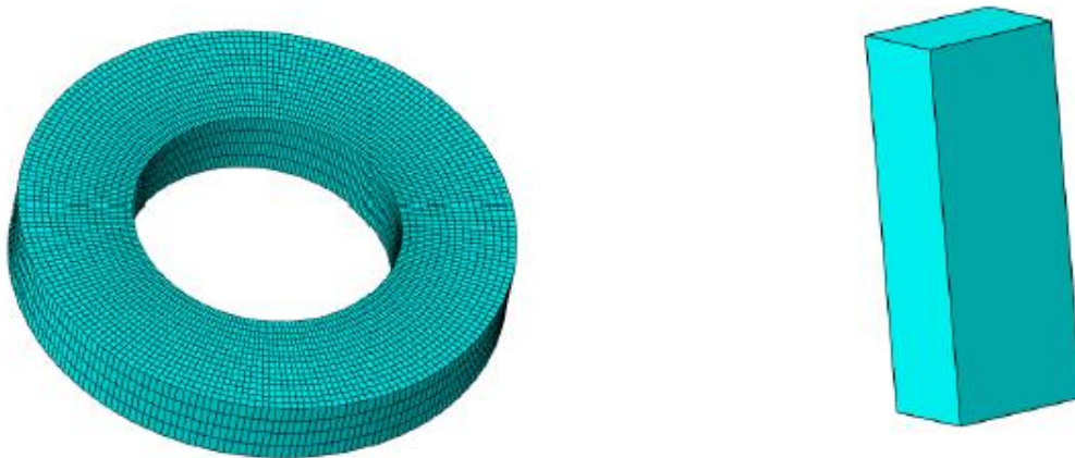
Figura 3.6: Mallado de la zona contigua al impacto y ejemplo del elemento usado (C3D8R).
