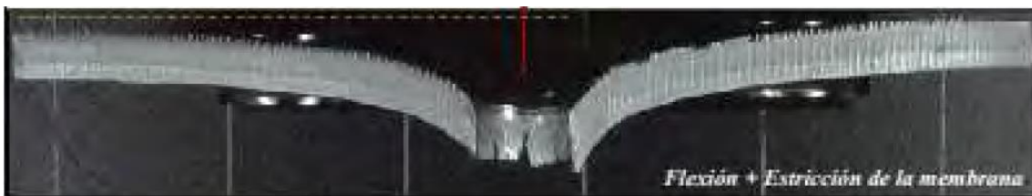
Figura 4.13: Sección transversal de la placa perforada con un proyectil de forma esférica a una velocidad de 179,86m/s.
