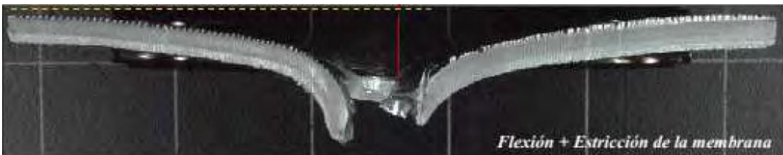
Figura 4.16: Sección transversal de la placa perforada con un proyectil de forma cónica a una velocidad de 148.81m/s.
