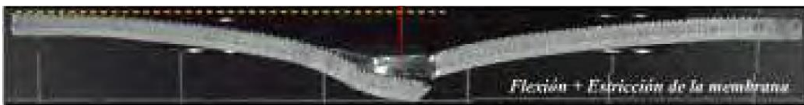
Figura 4.10: Sección transversal de la placa perforada con un proyectil de punta plana a una velocidad similar a su límite balístico(150,60m/s).
