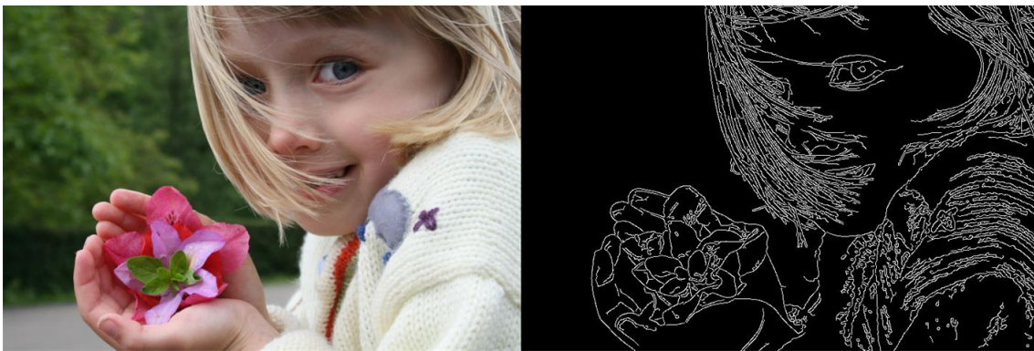
Figura - 19 - Fotografía tratada con la detección de bordes Canny.
