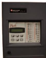
La central Park2000 dispone de 1 zona de detección, ampliable a 2 zonas. Cabina compacta que incluye 1 módulo de control, 1 módulo P100, fuente de alimentación y entrada para tensión de emergencia de 24Vcc.
