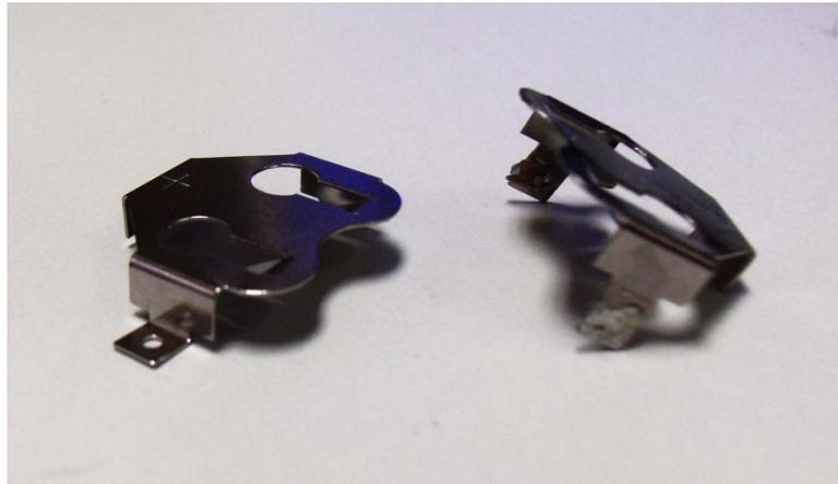
**Figura 3.19.** Soportes para pilas tipo botón.
