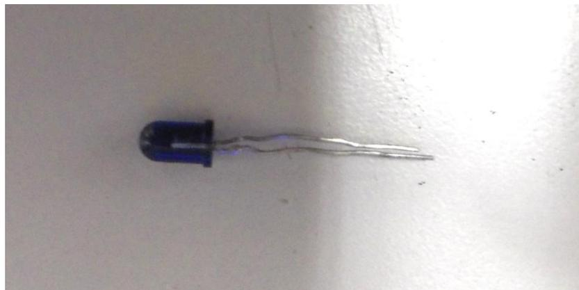
**Figura 3.7.** *Diodo emisor infrarrojo GL380.*
