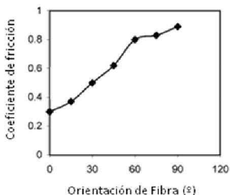
Fig 3.30: Variación del coeficiente de fricción con la orientación de fibra.
