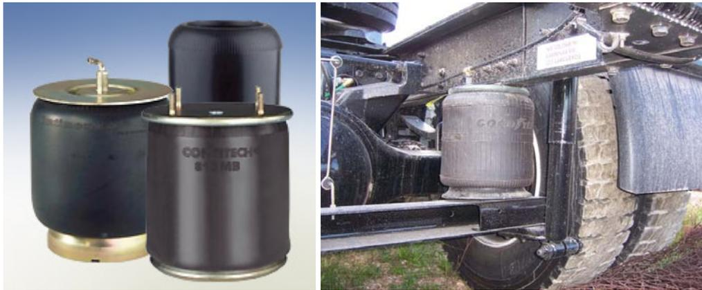
**Figura 14. Fuelles neumáticos sin montar y montados**
