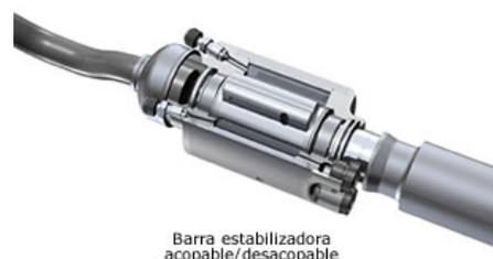
**Figura 32. Detalle del acoplamiento de garras de la barra estabilizadora**
