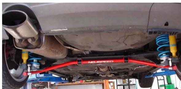
**Figura 21. Barra estabilizadora de un automóvil**
