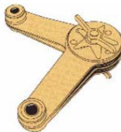
**Figura 9. Amortiguador de fricción**
