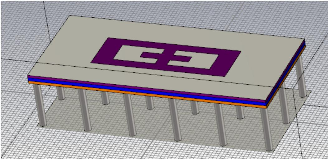
Figura 6.3: Dieléctrico debajo de la antena de doble banda
