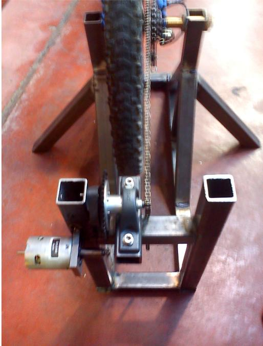
*Figura 13: Vista trasera del soporte con la cadena sin instalar*
