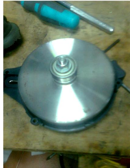
Figura 8: Vista superior del freno magnético
