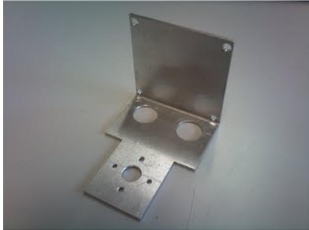
Figura 33: Placa acoplamiento del laser al motor.
