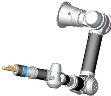
Figura 23: Brazo manipulador LWR-UC3M-1.
