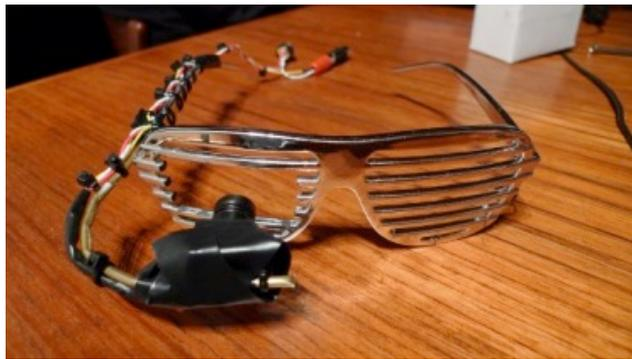
**Ilustración 5: Headmounted del proyecto "The eyewriter".**
