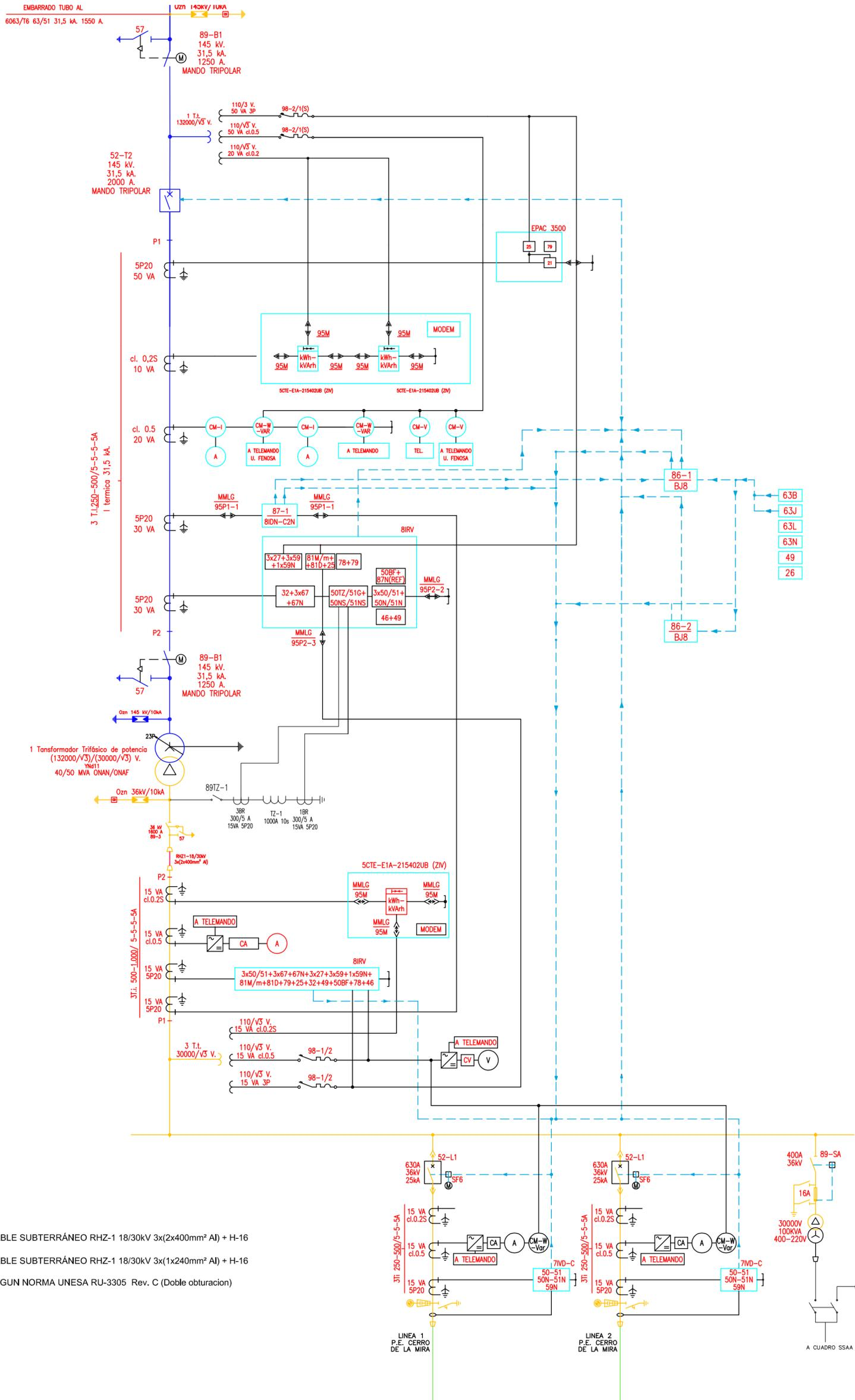
— CABLE SUBTERRÁNEO RHZ-1 18/30kV 3x(2x400mm<sup>2</sup> Al) + H-16
