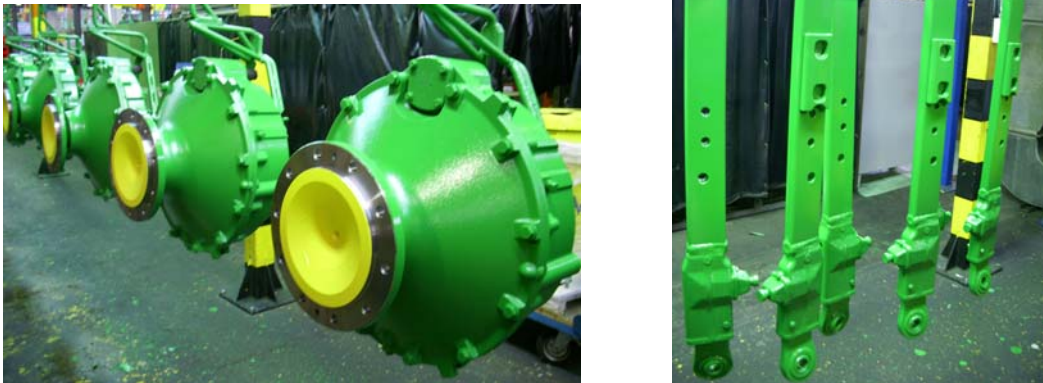
Figura 2.6 Mandos finales y enganches tripuntales producidos en John Deere Ibérica
