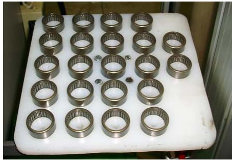
Figura 6.11 Mejora en el montaje de rodamientos
