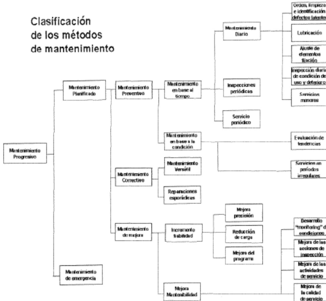
**Figura 2.3. Clasificación de los métodos de mantenimiento**
