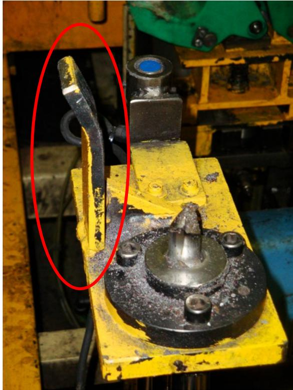
El proceso de situación del carro se puede apreciar en las siguientes figuras en las que se puede apreciar como la pletina que se puso empuja al carro hasta su posición correcta:
