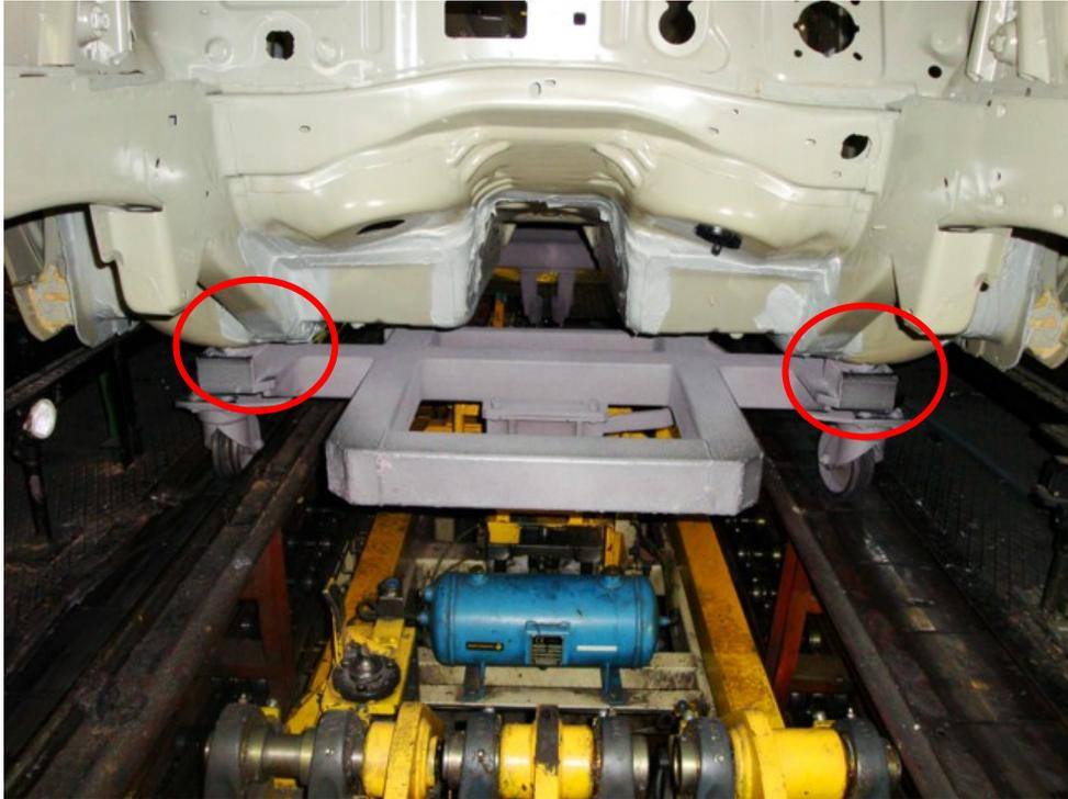
**Figura 4.32 Carrocería bien posicionada sobre carro**
