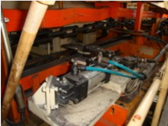
*Figura 4.18. Bloqueo o cerrojo de salida*
