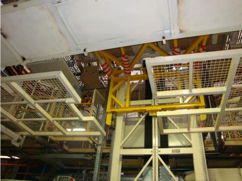
*Figura 4.25. Trampillas de seguridad*
