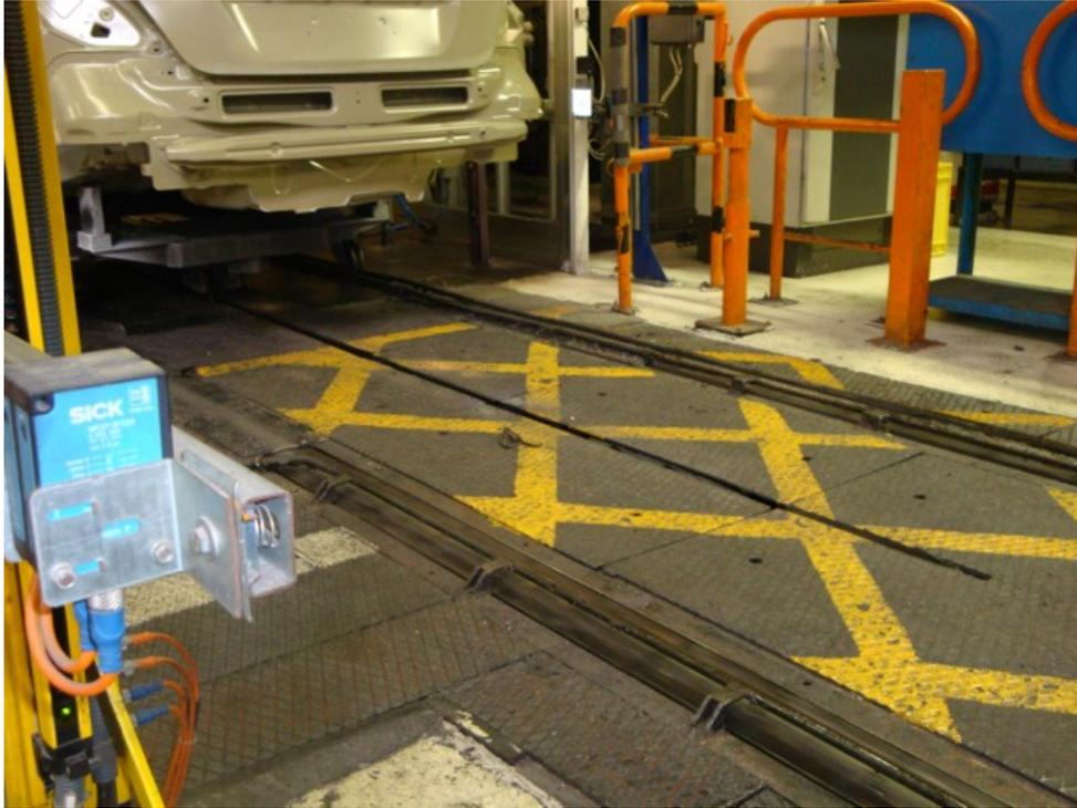
***Figura 4.34. Proceso de transferencia de la cadena de tablillas a la cadena de aprestos***
