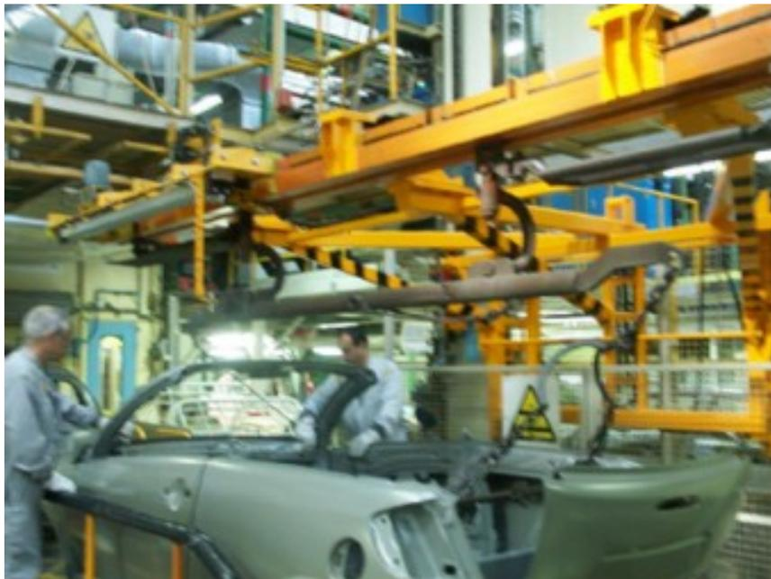
***Figura 1.1. Operarios trabajando en el Drop de carrocerías***
