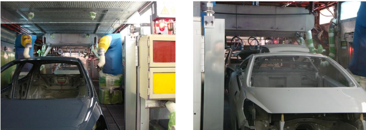
**Figura 4.33. Proceso de aplicación de los robots de imprimación**
