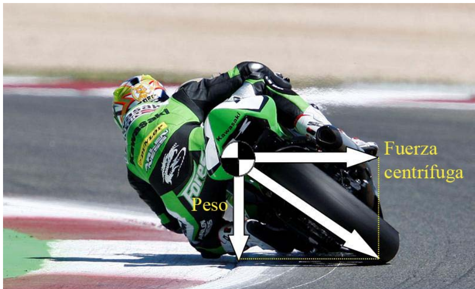
Figura 3.3.1: Esquema de fuerzas en un viraje
