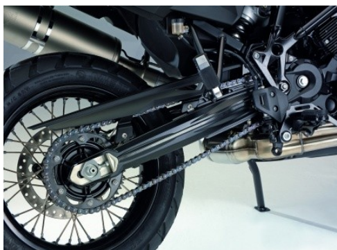
Figura 2.3.7.4.1: Transmisión secundaria por cadena
