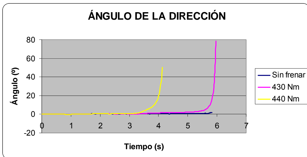
Figura 5.4.8: Ángulo del tren delantero de la motocicleta
