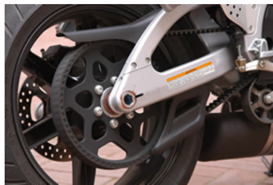
Figura 2.3.7.4.2: Transmisión secundaria por correa
