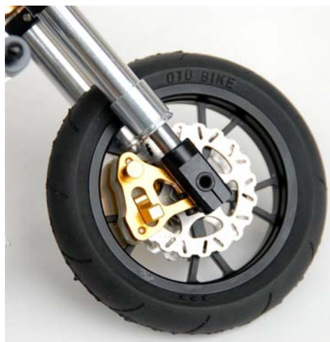
Figura 2.3.5.3: Freno de disco delantero
