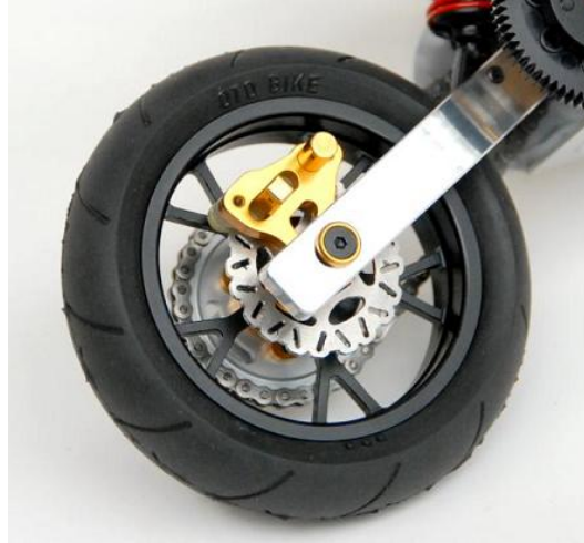
Figura 2.3.5.4: Freno de disco trasero
