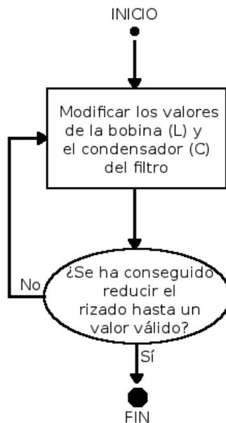
Fig. 45. Proceso iterativo para obtener los valores del condensador y la bobina del filtro
