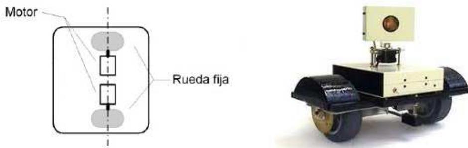
Figura 2.20: Configuración diferencial. (a) Estructura. (b) Robot Quiróptero.
