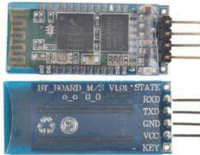
Figura 2.37: Módulo BT transceptor RS232 Arduino.
