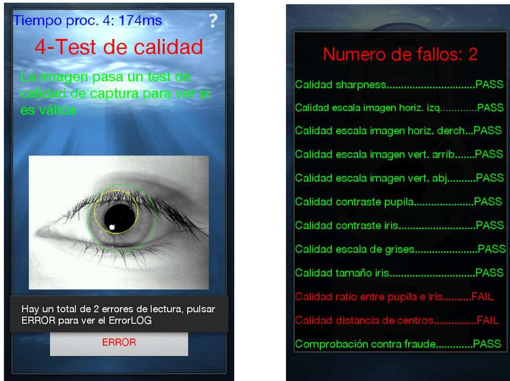
Figura 35: Test de calidad con varios fallos
