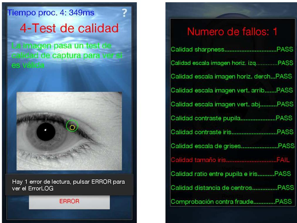
Figura 32: Test de calidad distancia de tamaño del iris
