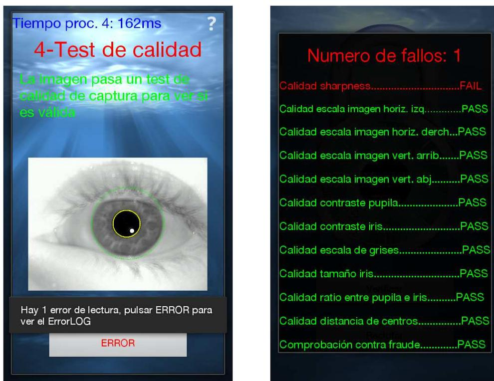
Figura 28: Test de calidad sharpness (enfoco)
