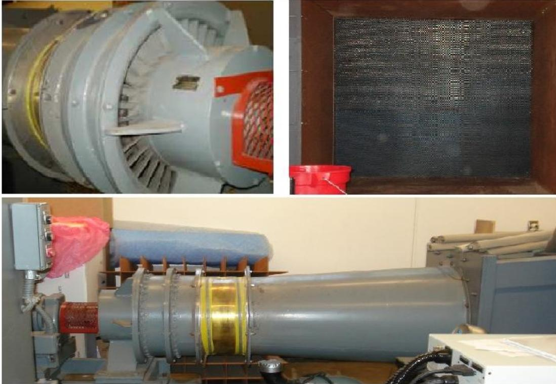
**Figura 12:** Imágenes del compresor y el panel de abeja. Arriba a la derecha panel de abeja de sección 1,2x1,2m. Arriba a la izquierda y abajo (en horizontal) el compresor axial GE 7A5 A1.
