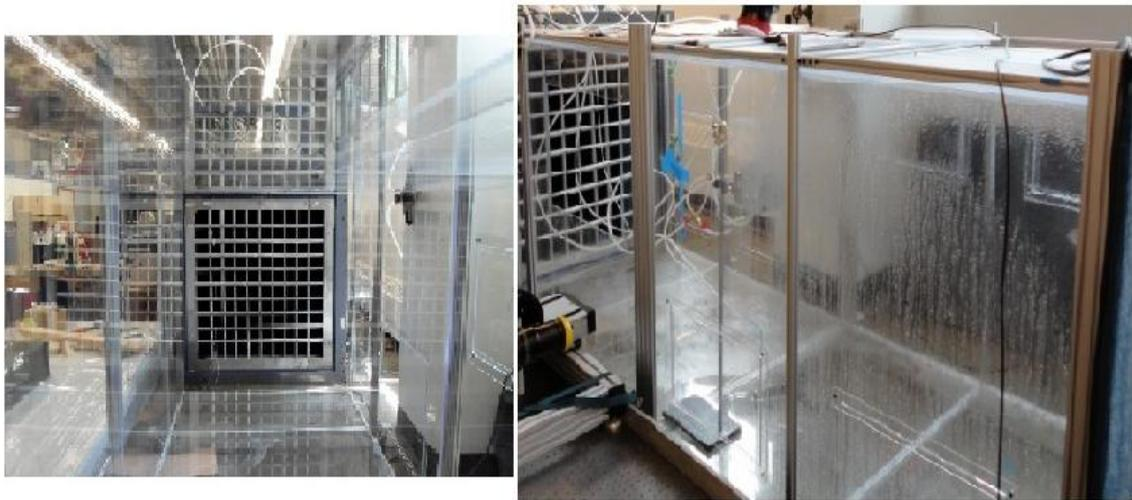
**Figura 13: Sección de experimentación. Vista interior aguas arriba (a la izquierda) y vista exterior con la estructura de aluminio (a la derecha)**
