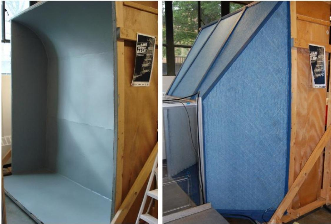
**Figura 14: Rain catcher. Geometría interior del rain cácher (a la izquierda) y conjunto montado al completo con filtro de aire incluido (a la derecha)**
