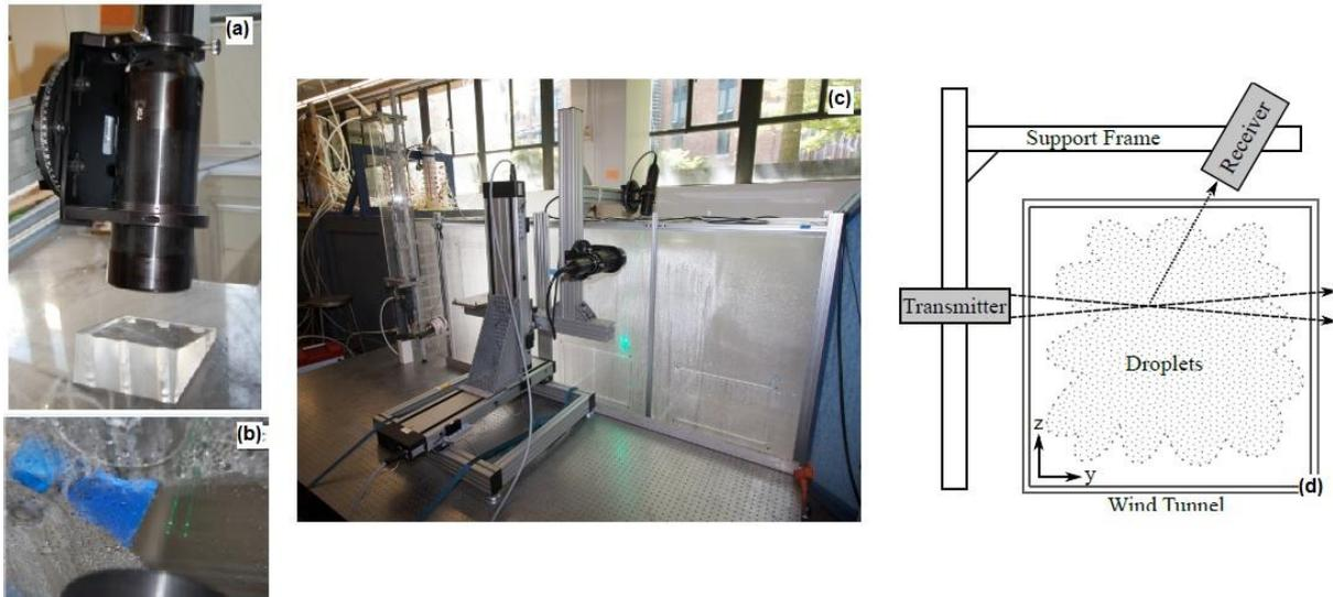
**Figura 36: Montaje del PDPA. (a) prisma; (b) cortina de aire; (c) sistema PDPA; (d) esquema de funcionamiento**
