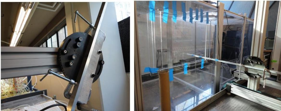
**Figura 35: Detalle de diferentes posiciones del soporte del hotwire**
