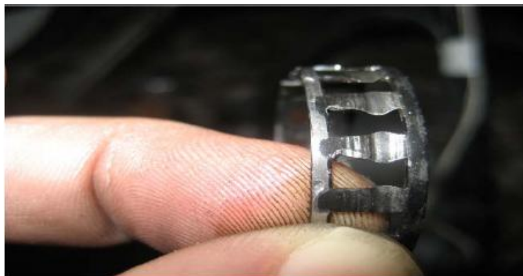
Figura 23. Rodamiento con la jaula deformada
