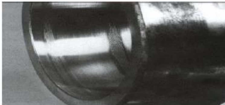
Figura 22. Smearing en un rodamiento
