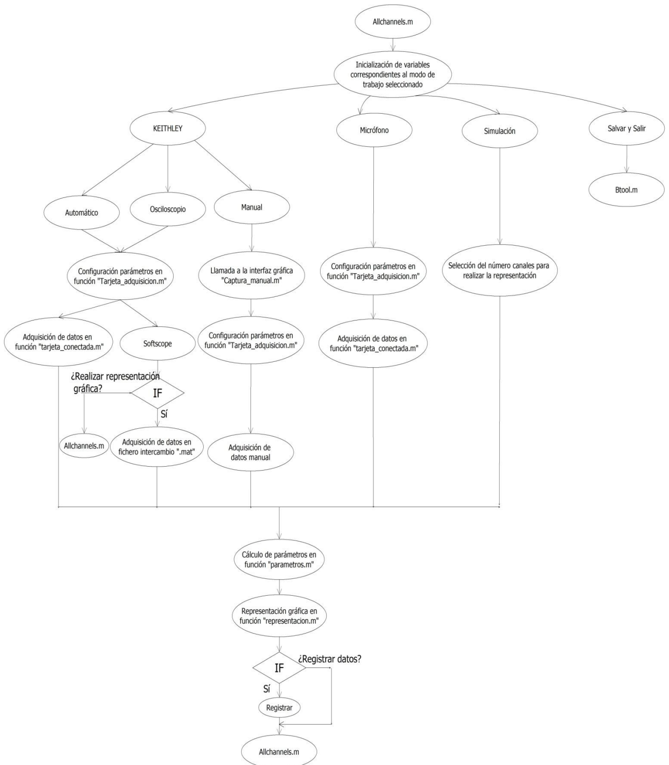
Figura 92. Diagrama de flujo de la función "Allchannels.m"
