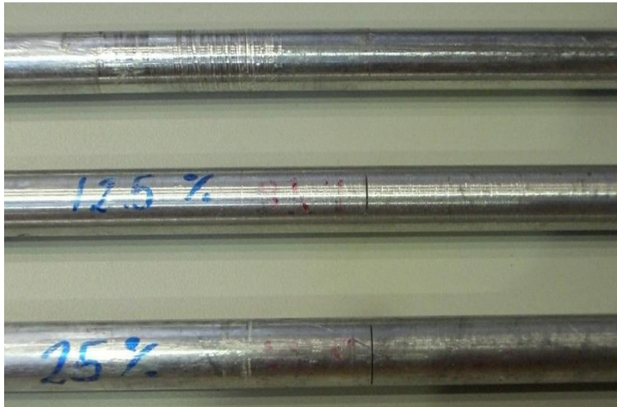
Figura 108. Ejes con diferentes tanto por ciento de fisuras
