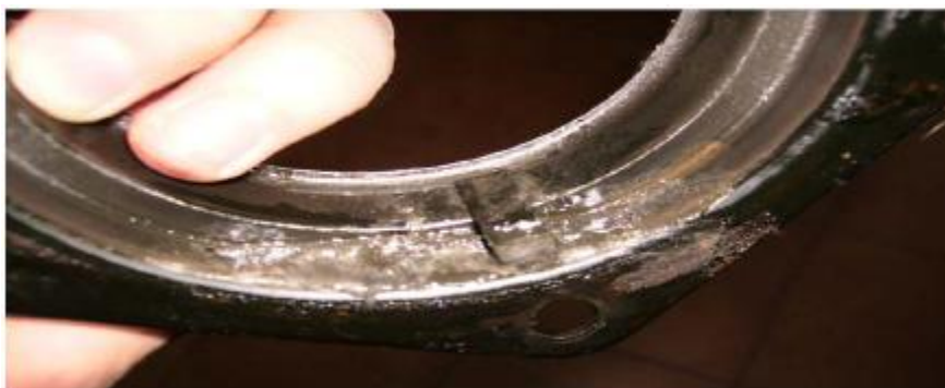
Figura 19. Rodamiento con desgaste debido a vibraciones mecánicas
