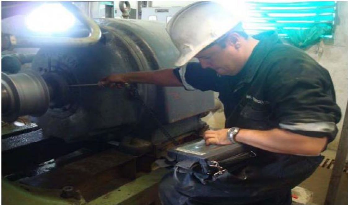
Figura 5. Técnico llevando a cabo un análisis por corriente eléctrica
