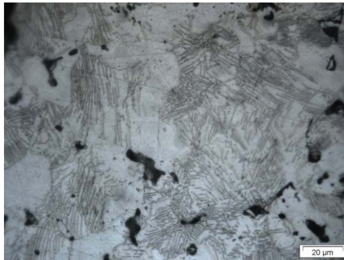
Figura 15. Detalle de la microestructura de la aleación Fe-G a 1120 °C.
