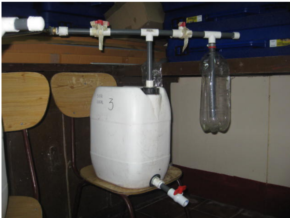
Fig. 19: Biodigestor con la válvula de seguridad. Fuente: Elaboración Propia
