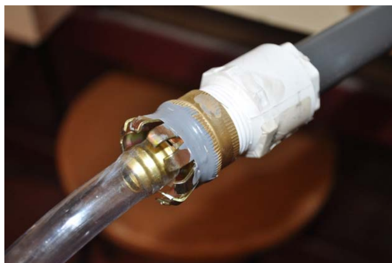
Fig. 15: Conexión con la manguera. Fuente: Elaboración propia
