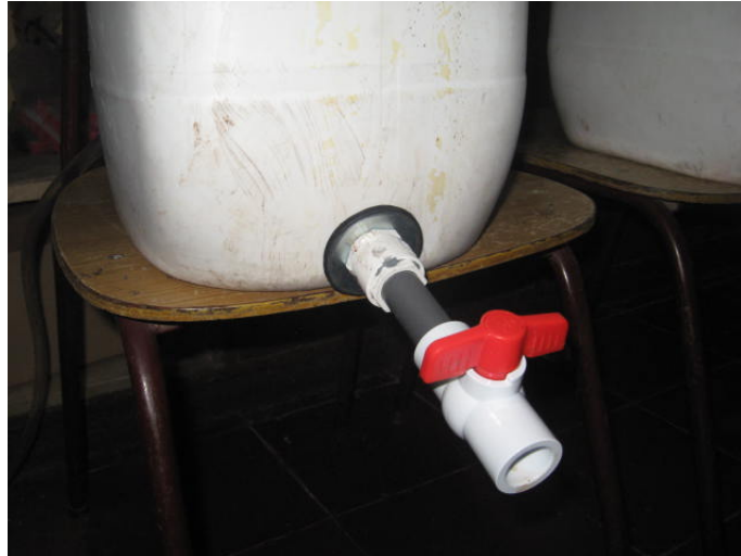
Fig. 18: Llave de paso en la parte inferior del bidón. Fuente: Elaboración propia
