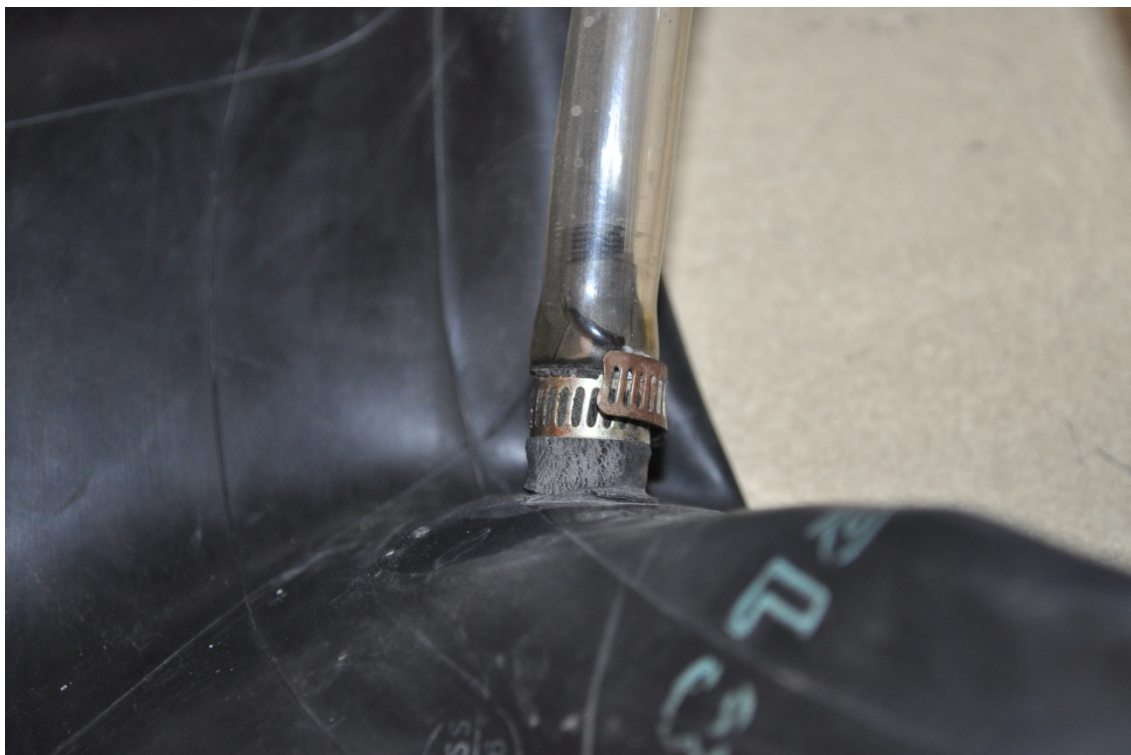
Fig. 17: Conexión neumático-manguera. Fuente: Elaboración propia
