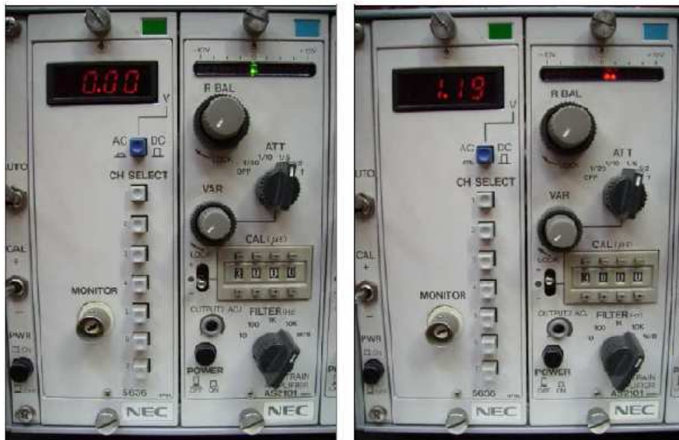
Figura 4.24.- Ejemplo de la utilización de los botones CAL
