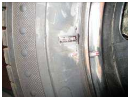
Figura 5.7.- Posición de una galga para la medida de deformaciones en el flanco externo radial
