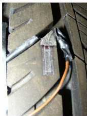
Figura 5.5.- Posición de una galga para la medida de deformaciones longitudinales en la banda de rodadura 1
