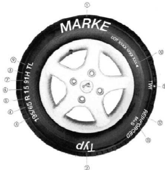
Figura 2.13.- Esquema de las inscripciones grabadas en los neumáticos
