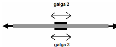
Figura 3.13.- Montaje en 1/2 puente para la medida de tracción ó compresión.
