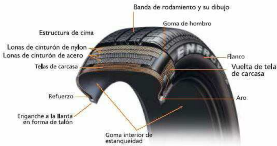
Figura 2.1.- Composición de un neumático.
