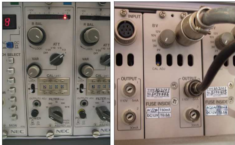
Figura 4.7.- Vista NEC AS2101 DC STRAIN AMPLIFIER, vista anterior y posterior.
