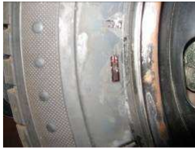
Figura 5.6.- Posición de una galga para la medida de deformaciones en el flanco externo longitudinal
