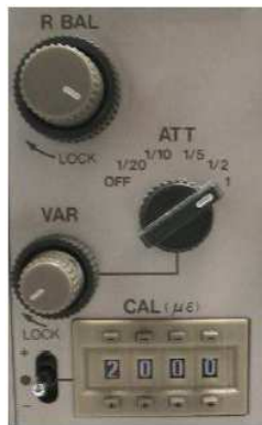
Figura 4.23.- Selectores de calibración del equipo amplificador
