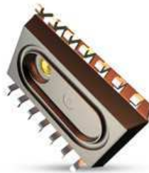
Figura 2.43.- Sensor de temperatura y presión integrado
