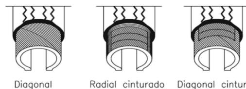
Figura 2.5.- Estructuras básicas de los neumáticos.
