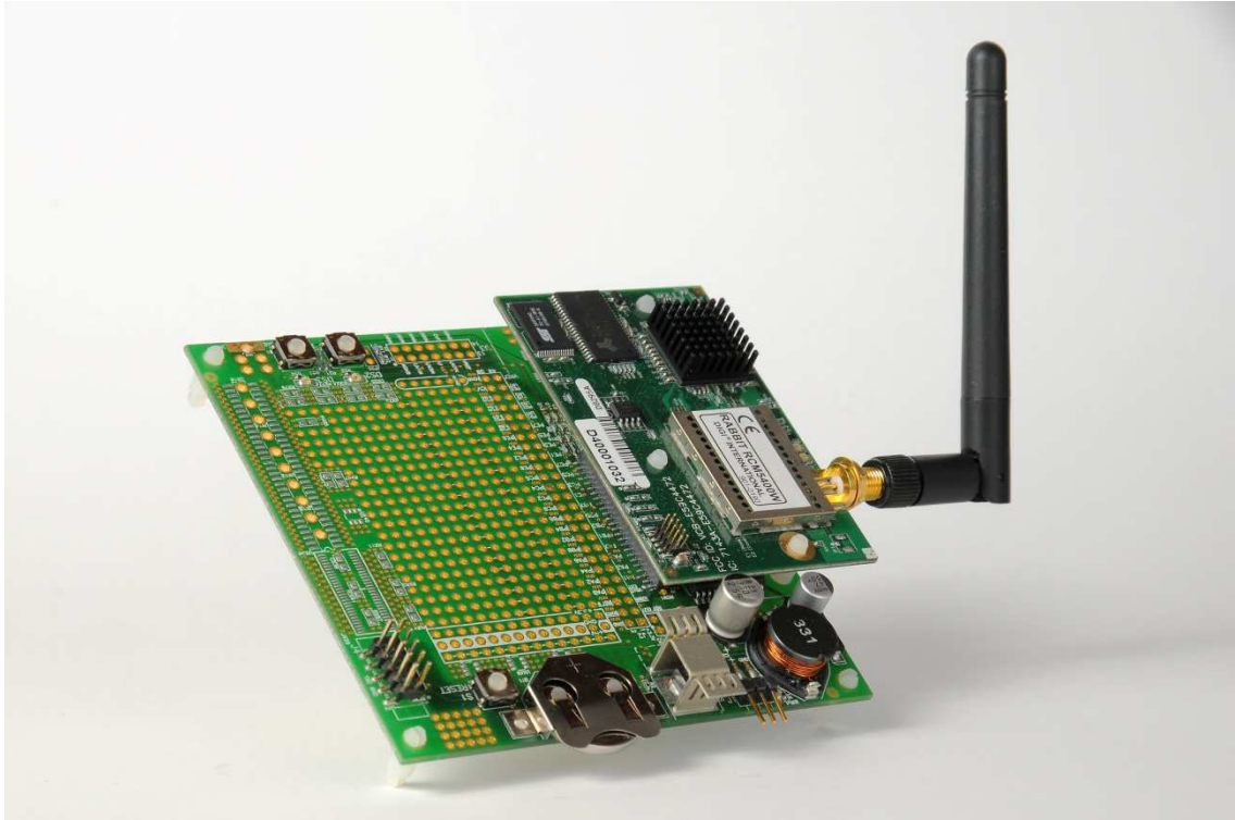
Figura 6.1. Módulo de control junto a placa de pruebas.
