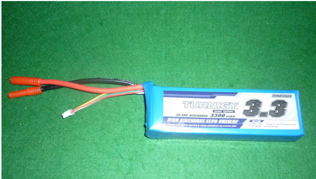
Figura 4.3. Batería de 14,7V y 3300mAh.
