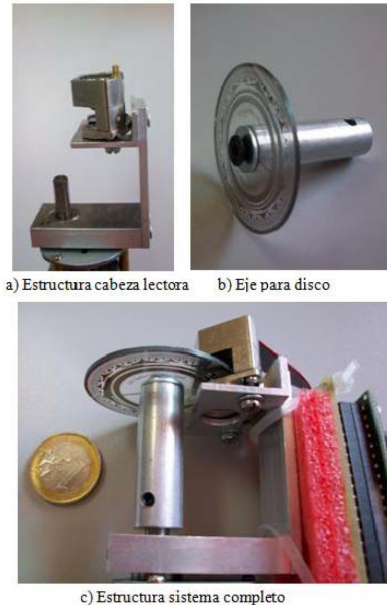
Figura 50: Sistema Mecánico Diseñado para el Desarrollo del Encoder.
