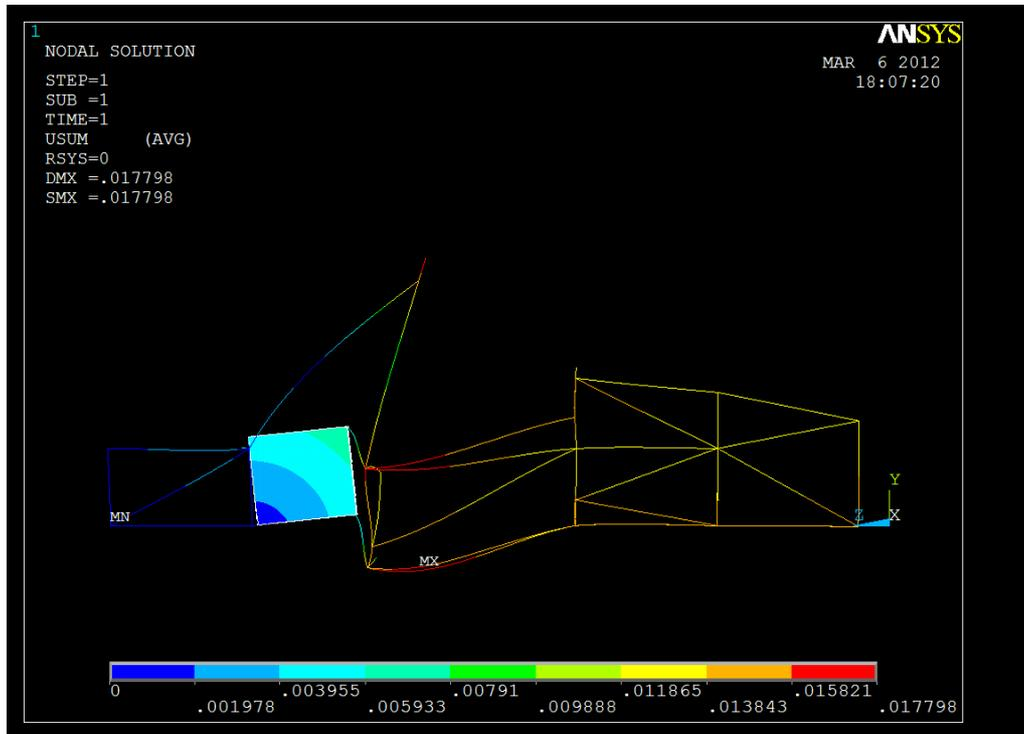
*Deformación total del chasis en aceleración.*
