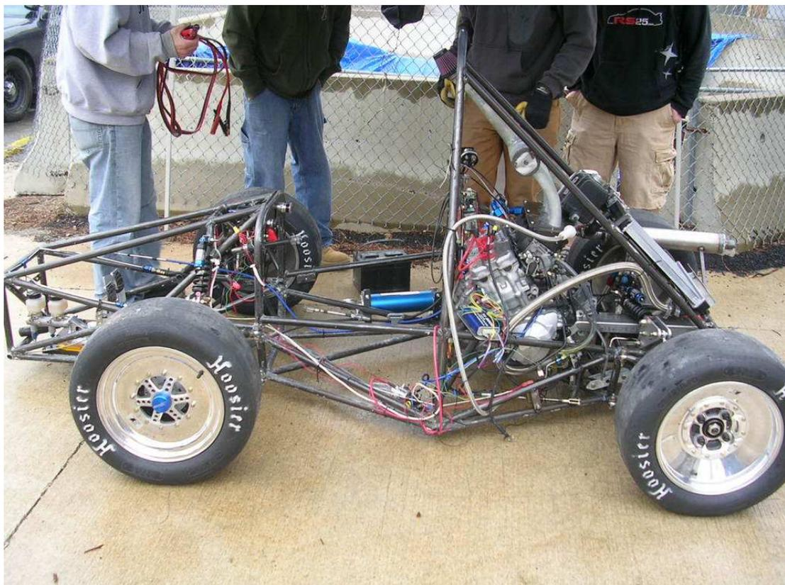
*Chasis formula SAE con cableado, ruedas y motor.*
