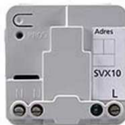
Figura 6.7.4. Amplificadores de señal de la casa Xanura SVX10
