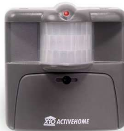
Figura 6.5.3.5. Un detector de movimiento X10
