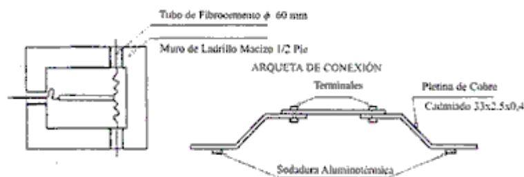
Figura 5.13.3. Puente de pletina de cobre
