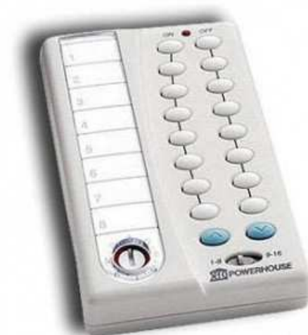
Figura 6.5.2.5. Controlador a distancia Palm Pad
