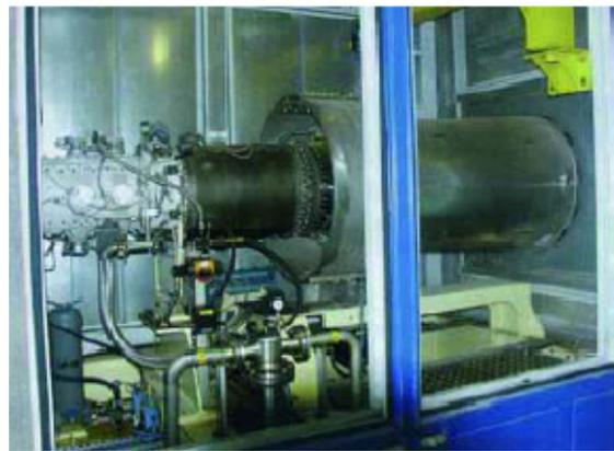
Figura 6: Turbina de gas de 3,8 MW. Papelera Oria
